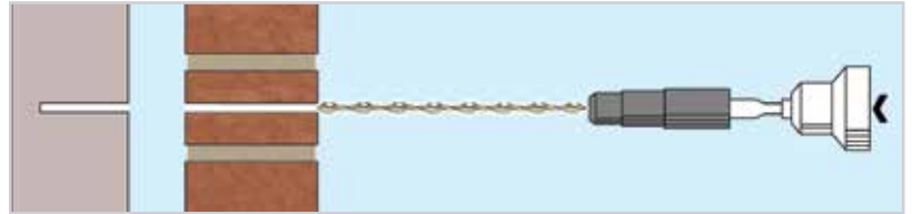
2. Breng het anker aan in het DryFix indrijfhelpstuk dat is aangebracht op de SDS-hamerboor
