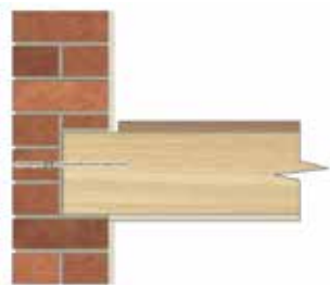
BowTie in balkuiteinde door een massieve muur
